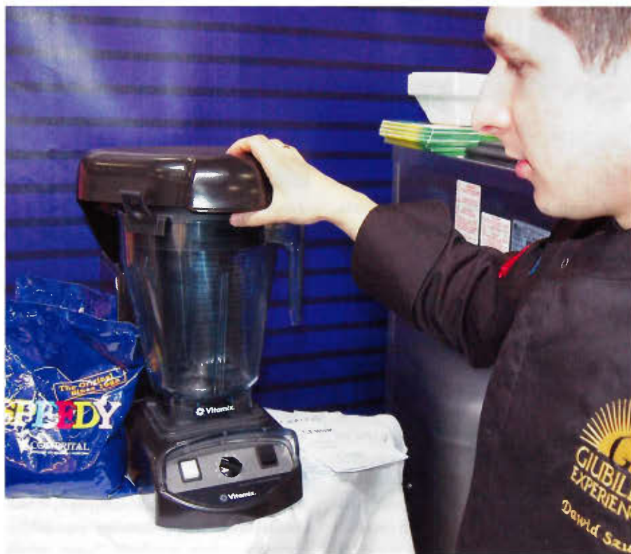
To niepozornie wyglądające urządzenie pracuje z prędkością ponad 30 000 obr./min, co pozwala rozdrobnić cząsteczki mieszanki lodowej do wielkości zaledwie 50 mikrometrów. Fot. B&S
